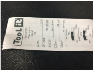
Elektrik donanımı/Pano, Akü > Test Sonucu
