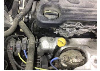
Motor, Motor üst kapağı, plastik > Yağ Kaçağı
