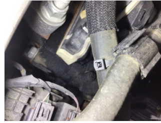
Motor, Motor üst kapağı, plastik > Yağ Kaçağı
