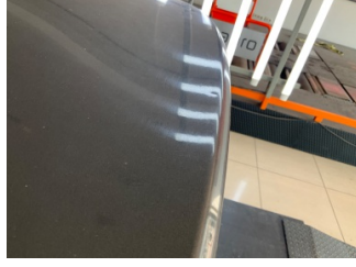
Bagaj kapağı/kapısı, Bagaj kapısı > Noktasal Ezik
