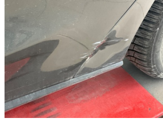
Kapı, sol arka, Kapı, sol arka > Hasarlı
