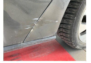
Çamurluk, sol arka, Çamurluk, sol arka > Hasarlı
