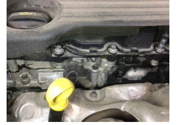
Motor, Motor üst kapağı, plastik > Yağ Kaçığı
