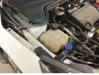
Motorsoğutması, Soğutma sıvısı > Eksik
