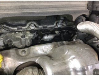
Motor, Motor üst kapağı, plastik > Yağ Kaçığı
