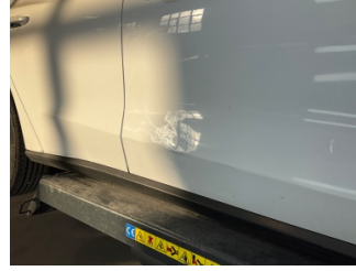
Kapı, sağ ön, Kapı, sağ ön > Hasarlı
