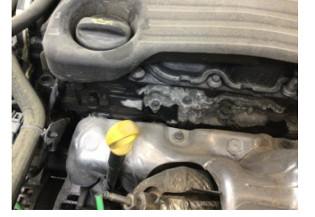
Motor, Motor üst kapağı, plastik > Yağ Kaçağı
