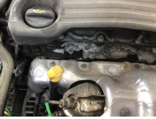
Motor, Motor üst kapağı, plastik > Yağ Kaçağı
