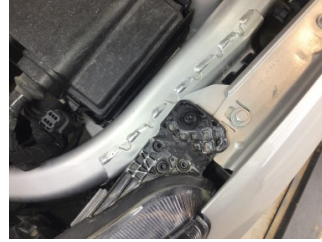
Farlar, Far, sol > Hasarlı
