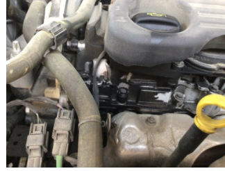
Motor, Motor üst kapağı, plastik > Yağ Kaçağı
