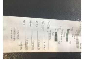
Elektrik donanımı/Pano, Akü > Test Sonucu
