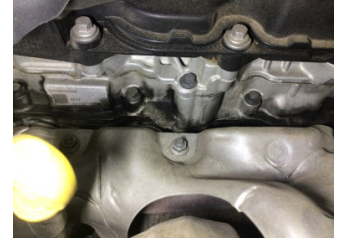
Motor, Motor üst kapağı, plastik > Yağ Kaçağı
