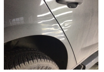
Çamurluk, sağ arka, Çamurluk, sağ arka > Ezik
