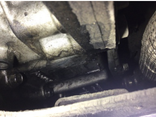
Şanzıman, Şanzıman > Yağ Kaçağı
