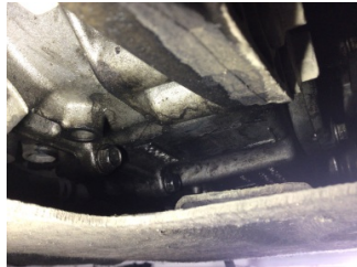
Şanzıman, Şanzıman > Yağ Kaçağı
