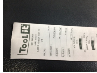
Elektrik donanımı/Pano, Akü > Test Sonucu
