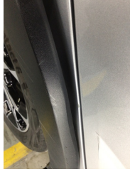
Çamurluk, sağ arka, Çamurluk ağız > Hasarlı
