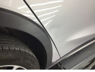
Kapı, sağ arka, Kapı, sağ arka > Ezik
