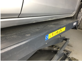
Marşbiyel, sağ, Marşbiyel, sağ > Hasarlı
