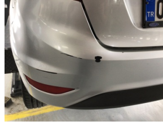
Tampon, arka, Arka tampon > Boyası Atmış
