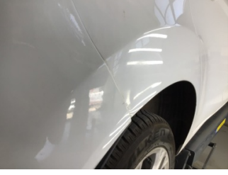
Çamurluk, sağ arka, Çamurluk, sağ arka > Ezik
