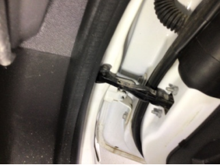
Kapı, sağ ön, Kapı gergisi > Ses Yapıyor
