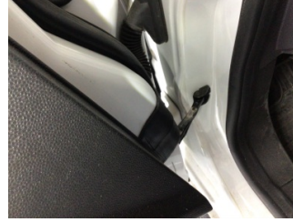
Kapı, sol ön, Kapı gergisi > Ses Yapıyor
