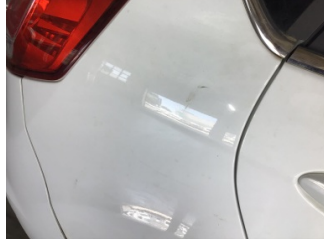
Çamurluk, sağ arka, Çamurluk, sağ arka > Ezik
