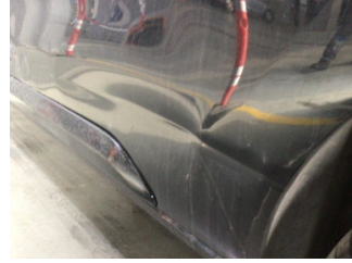
Çamurluk, sol arka, Çamurluk, sol arka > Hasarlı
