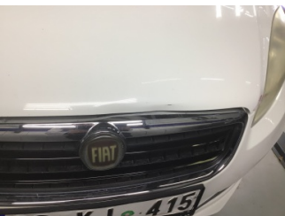
Motor kaputu, Motor kaputu > Hasarlı
