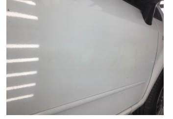
Kapı, sağ ön, Kapı, sağ ön > Boyası Atmış
