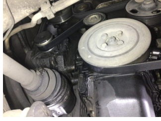
Motor, Triger zinciri kapağı > Yağ Kaçağı
