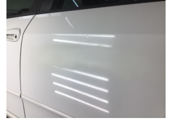
Kapı, sol arka, Kapı, sol arka > Boyası Atmış
