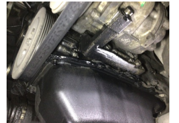
Motor, Yağ karteri > Yağ Kaçığı
