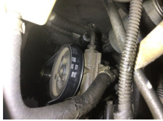
Direksiyon sistemi, Hidrolik pompası > Yağ Kaçığı
