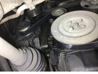
Motor, Triger zinciri kapağı > Yağ Kaçağı
