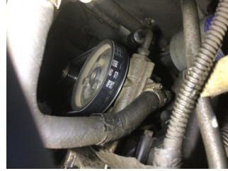
Direksiyon sistemi, Hidrolik pompası > Yağ Kaçığı
