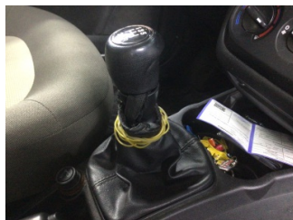
Şanzıman, Vites körüğü > Deforme Olmuş
