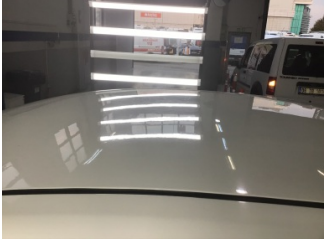
Tavan, Tavan > Dolu Hasarı
