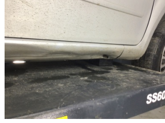
Marşbiyel, sağ, Marşbiyel, sağ > Hasarlı
