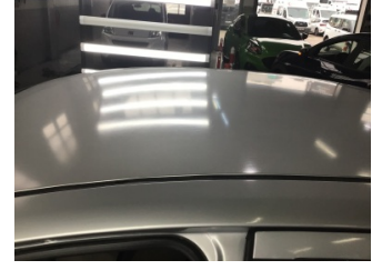
Tavan, Tavan > Dolu Hasarlı
