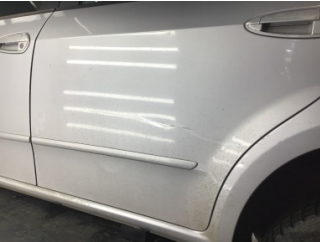
Kapı, sol arka, Kapı, sol arka > Çizik
