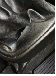
Şanzıman, Vites körüğü > Hasarlı
