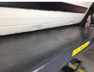
Marşbiyel, sol, Marşbiyel, sol > Hasarlı
