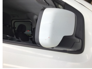
Dikiz aynası, sağ, Dış dikiz aynası > Çizik
