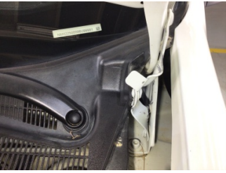
Motor kaputu, Menteşe > Hasarlı
