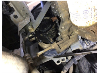
Direksiyon sistemi, Hidrolik pompası > Yağ Kaçağı
