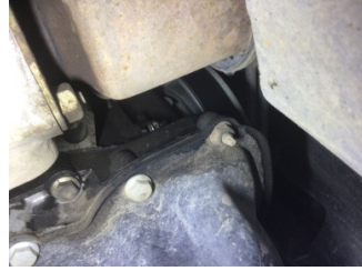
Motor, Triger zinciri kapağı > Yağ Kaçağı
