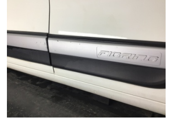
Kapı, sol arka, Kapı bandı > Çizik
