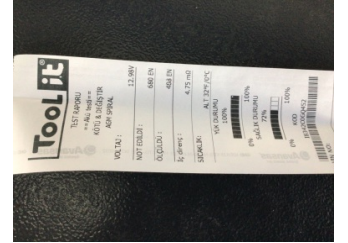
Elektrik donanımı/Pano, Akü > Test Sonucu
