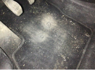
Taban, Paspaslar > Deforme Olmuş
