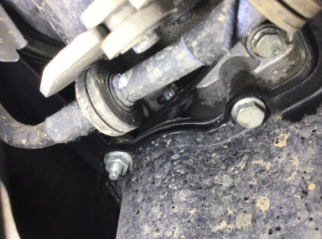
Motor, Triger zinciri kapağı > Yağ Kaçağı
