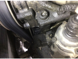
Motor, Triger zinciri kapağı > Yağ Kaçağı
