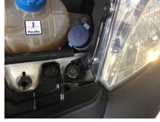
Farlar, Far bağlantı ayağı, sol > Hasarlı
