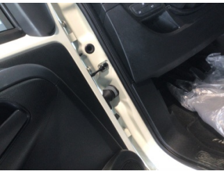
Kapı, sol ön, Kapı gergisi > Ses Yapıyor
