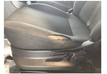
Koltuklar, ön, Koltuk, sol ön > Deforme Olmuş
