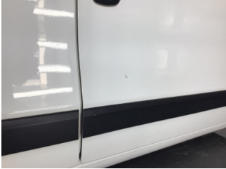
Kapı, sağ ön, Kapı, sağ ön > Çizik
