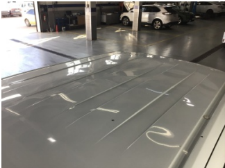
Tavan, Tavan > Hasarlı
