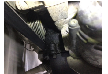
Motor, Triger zinciri kapağı > Yağ Kaçağı
