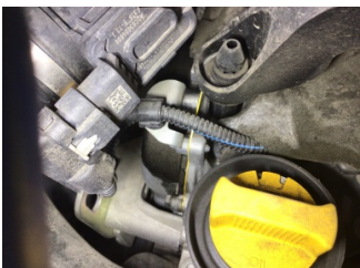
Motor, Triger zinciri kapağı > Yağ Kaçağı
