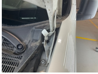
Motor kaputu, Menteşe > Hasarlı
