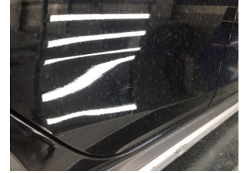
Kapı, sağ arka, Kapı, sağ arka > Çizik
