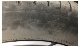
Lastik, ön > Hasarlı
