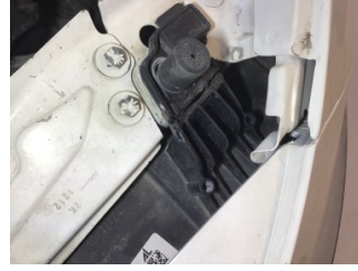
Farlar, Far bağlantı ayağı, sol > Hasarlı
