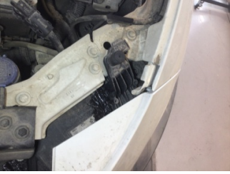
Farlar, Far bağlantı ayağı, sol > Hasarlı
