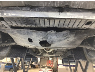
Motor, Alt muhafaza > Hasarlı
