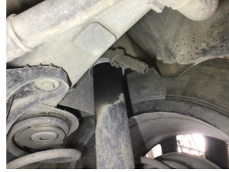
Arka aks, Amortisör, arka sağ > Sızdırıyor
