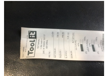
Elektrik donanımı/Pano, Akü > Test Sonucu
