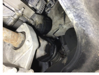
Motor, Yağ filtresi > Yağ Kaçağı
