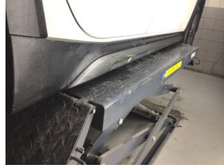
Marşbiyel, sağ, Marşbiyel plastığı, sağ > Çizik
