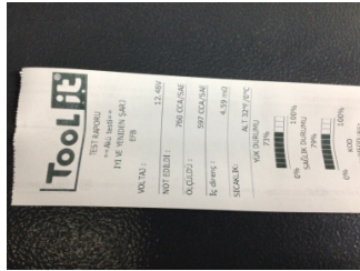
Elektrik donanımı/Pano, Akü > Test Sonucu
