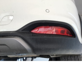
Tampon, arka, Reflektör, sağ > Çatlak
