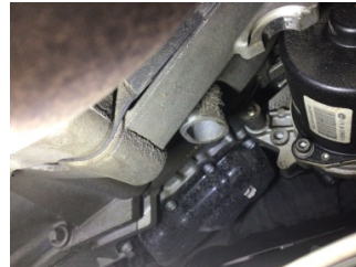
Şanzıman, Şanzıman > Yağ Kaçağı
