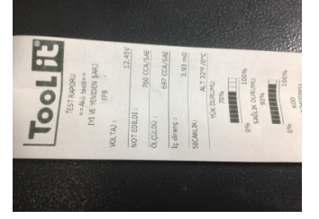
Elektrik donanımı/Pano, Akü > Test Sonucu
