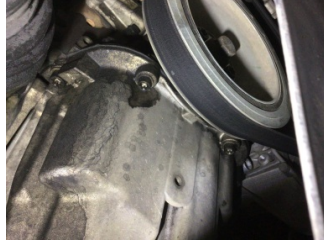
Motor, Yağ karteri contası > Yağ Kaçağı
