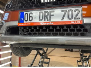
Tampon, ön, Ön tampon ızgarası > Hasarlı
