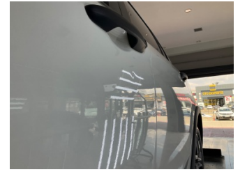
Kapı, sol ön, Kapı, sol ön > Noktasal Ezik
