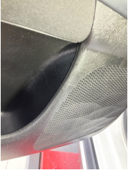
Döşemeler/Kapaklar, Kapı döşemesi, sol arka > Çizik
