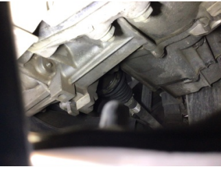
Ön aks, Aks mili, sol > Yağ Kaçağı
