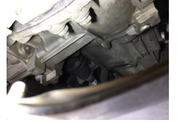
Ön aks, Aks mili, sol > Yağ Kaçağı
