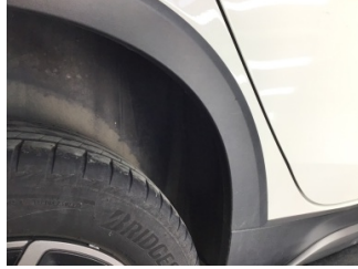
Çamurluk, sağ arka, Çamurluk ağzı > Çizik
