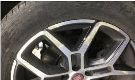
Jant, sağ ön > Hasarlı
