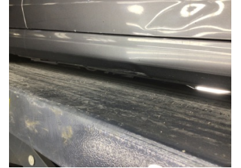
Marşbiyel, sağ, Marşbiyel, sağ > Hasarlı
