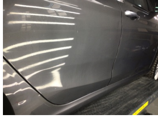
Kapı, sağ arka, Kapı, sağ arka > Ezik
