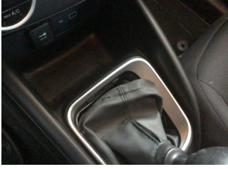
Şanzıman, Vites körüğü > Deforme Olmuş
