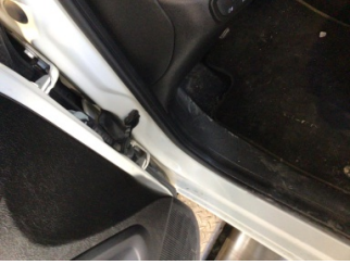
Kapı, sol ön, Kapı gergisi > Ses Yapıyor
