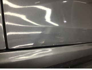
Kapı, sol ön, Kapı, sol ön > Ezik
