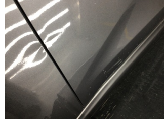
Kapı, sol ön, Kapı, sol ön > Ezik
