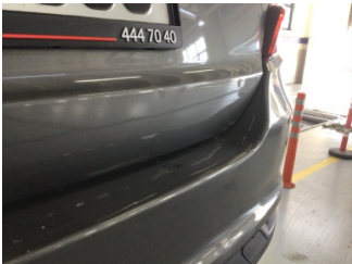
Bagaj kapağı/kapısı, Bagaj kapısı > Noktasal Ezik
