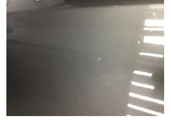
Kapı, sol ön, Kapı, sol ön > Ezik
