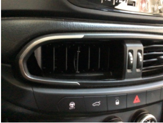
Kalorifer/Klima, Havalandırma ızgarası > Hasarlı
