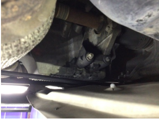
Motor, Alt muhafaza > Hasarlı
