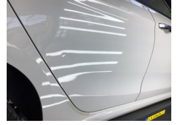
Kapı, sağ arka, Kapı, sağ arka > Ezik
