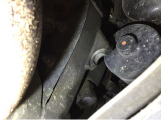
Şanzıman, Şanzıman > Yağ Kaçağı
