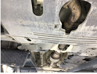
Motor, Alt muhafaza > Hasarlı
