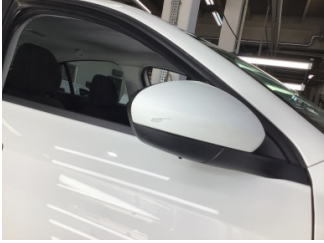
Dikiz aynası, sağ, Dış dikiz aynası > Çizik
