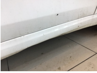
Marşbiyel, sağ, Marşbiyel, sağ > Hasarlı
