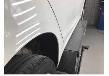
Çamurluk, sağ arka, Çamurluk, sağ arka > Ezik
