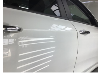
Kapı, sağ arka, Kapı, sağ arka > Ezik
