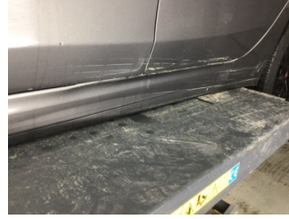
Marşbiyel, sol, Marşbiyel, sol > Hasarlı
