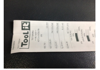
Elektrik donanımı/Pano, Akü > Test Sonucu
