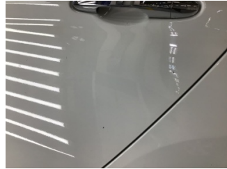
Kapı, sol arka, Kapı, sol arka > Çizik
