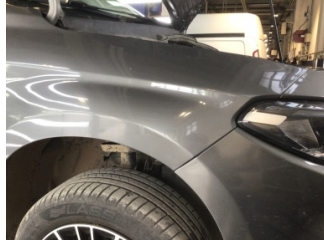
Çamurluk, sağ, Çamurluk, sağ > Küçük Çizik
