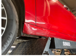
Marşbiyel, sol, Marşbiyel, sol > Hasarlı
