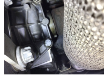
Ön aks, Aks mili, sol > Yağ Kaçağı
