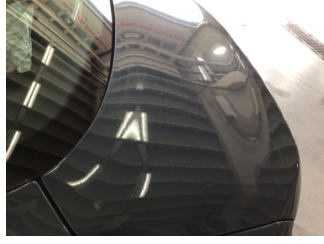
Bagaj kapağı/kapısı, Bagaj kapısı > Noktasal Ezik
