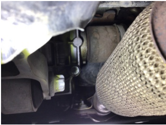
Ön aks, Aks mili, sol > Yağ Kaçağı
