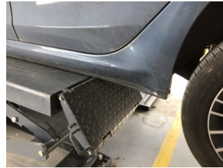
Marşbiyel, sol, Marşbiyel, sol > Hasarlı
