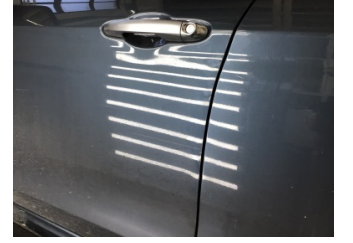
Kapı, sol ön, Kapı, sol ön > Çizik
